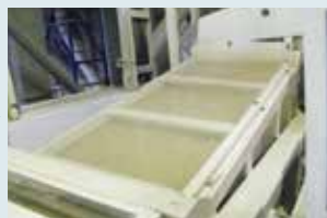
比重選別機で玄米だけに選別します。
