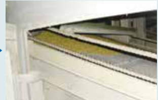
粗選機で籾に混入しているワラやゴミなどを取り除きます。
