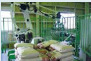
ロボットで袋づめした玄米を積み上げます。
