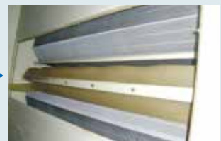
粒選別機で未熟粒や碎米などを取り除き玄米を一定の大きさにします。
