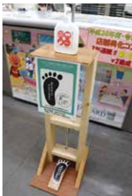
須恵支所に設置されている足踏み式消毒スタンド
